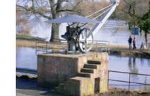
Im Bereich des historischen Höchstes Flusshafens auf vermutlich barockem Sandsteinsockel gelagerter Dreh- und Schwenkkrane des ausgehenden 19. Jahrhunderts, der mittels Zahnradgetriebe von Hand bewegt werden konnte.
