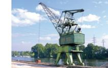
Der markante Wipprekran ist das letzte Relikt des 1911 errichteten, 2004 abgebrochenen Elektrizitätswerkes der Mainkraftwerke AG. Der 1954 von MAN gebaute Kran (Tragkraft 3 t) diente fast ein halbes Jahrhundert lang zum Entladen der Kohleschiffe und wurde 2006 als Zeuge für die industrielle Vergangenheit in die neu gestaltete Grünanlage am Mainufer eingebunden.
